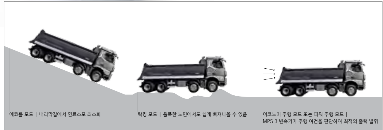
MPS 3 주행 기능 | 어떠한 주행환경에서도 최적의 효율을 발휘하여 다양한 기능을 제공합니다. (에코롤 모드/락킹모드/이코노미 주행 모드 또는 파워 주행 모드)
