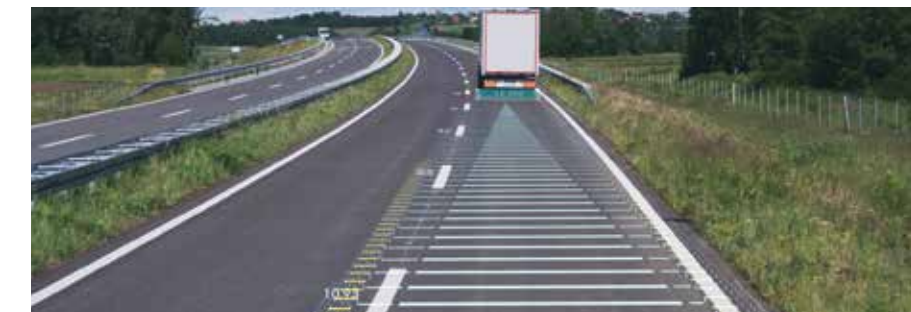
차선 내 차량 위치를 설정 할 수 있으며 곡선에서도 차선 내로 운행할 수 있도록 차선을 유지합니다.
