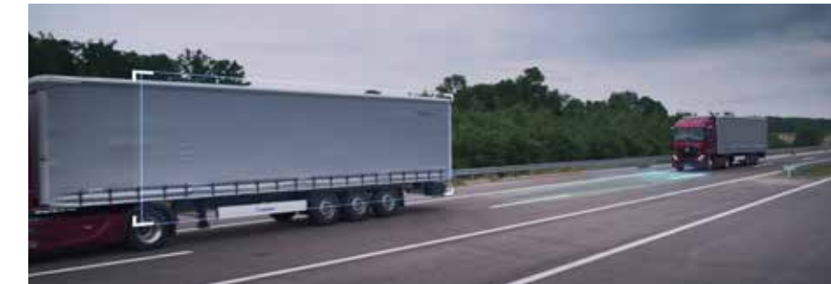
미리 설정된 앞 차량의 거리를 감지해 스스로 차간거리를 유지합니다.
