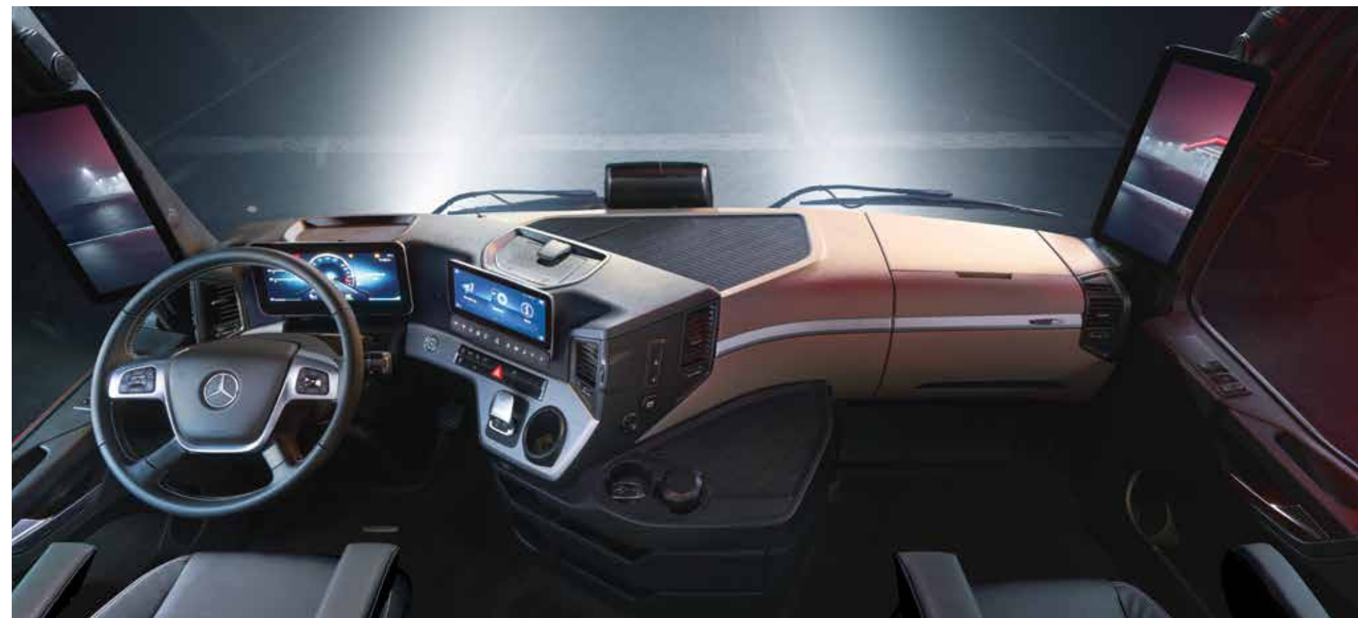
운전석 좌우 대형 미러캠 디스플레이는 넓은 시야각과 운전 정보를 제공하여 운전자는 실내에서 모든 상황을 파악하며 조향할 수 있습니다.
