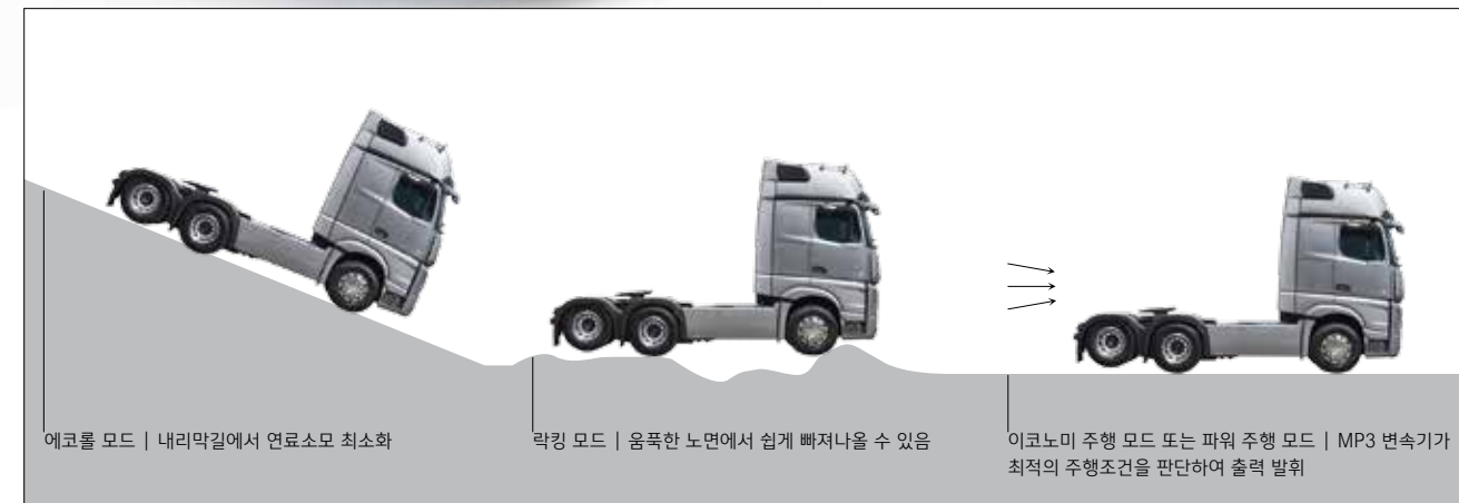
MP3 주행 기능 | 어떠한 주행환경에서도 최적의 효율을 발휘하여 다양한 기능을 제공합니다. (에코롤 모드 / 락킹모드 / 이코노미 주행 모드 또는 파워 주행 모드)
