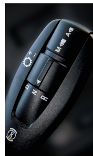
고성능 엔진 브레이크(HPB) 및 작동 레버 (변속 레버 겸용) | 총 제동력을 약 408마력으로 크게 높여 줍니다.
