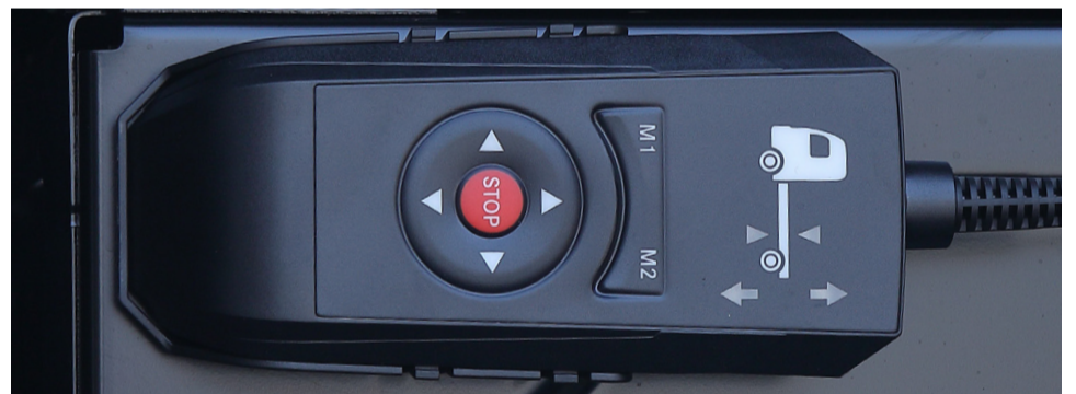
레벨 컨트롤 상황에 따라 적재부의 높이를 자유롭게 편리하게 조절하고 적재 및 하차에도 편리합니다.
