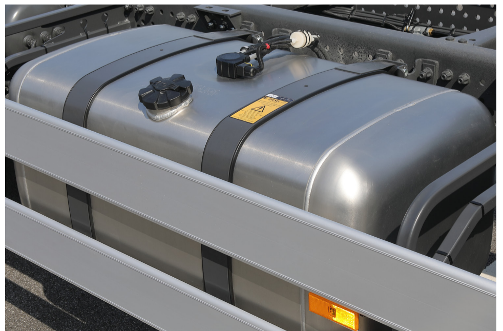
알루미늄 연료탱크 (390L) 경량 재료로 부식 방지 및 내구성이 뛰어납니다.
