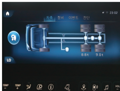
축하중 표시장치 운전자가 손쉽게 축하중을 모니터링하여 과부하를 방지할 수 있습니다.(사진 : 6X4 예시)
