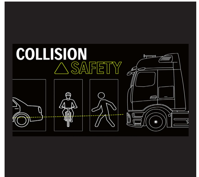
프론트가드 어시스트 차량 전방 사각지대를 감지하여 정차·출발·교차로 상황에서 보행자와 자전거를 인식하고, 경고를 통해 사고를 예방합니다.
