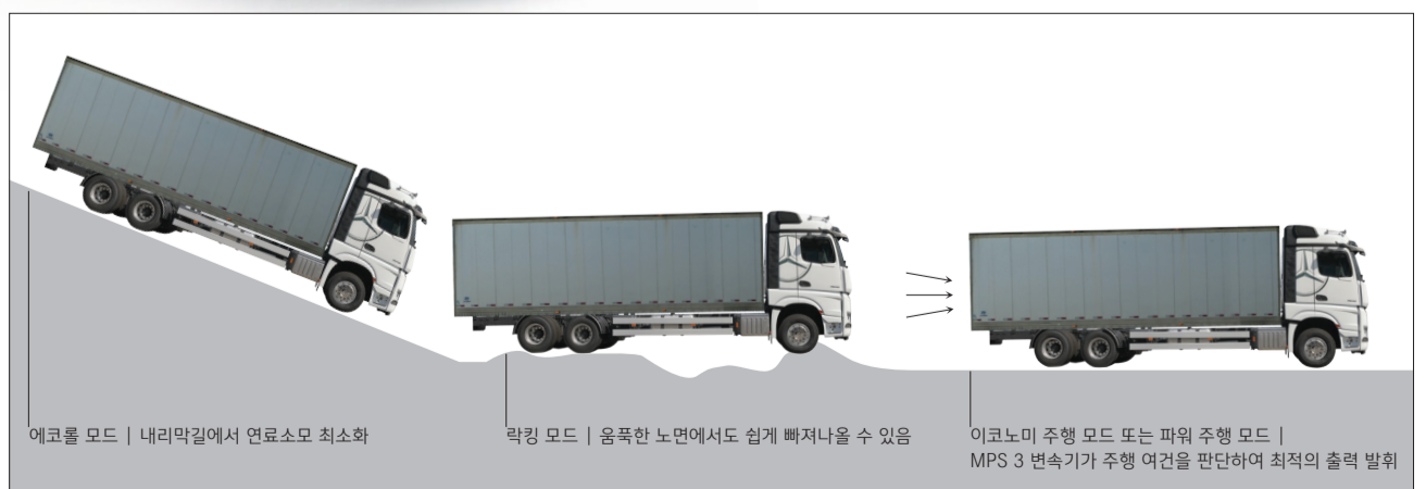
MPS 3 주행 기능 | 어떠한 주행환경에서도 최적의 효율을 발휘하여 다양한 기능을 제공합니다. (이코롤 모드/락킹모드/이코노미 주행 모드 또는 파워 주행 모드)
