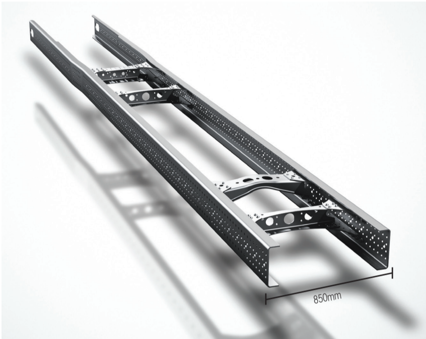
고장력 프레임 이전 모델에 비해 넓어진 고장력 프레임을 적용하여 차량 내구성은 물론 주행/적재 안정성 또한 크게 향상되었습니다
