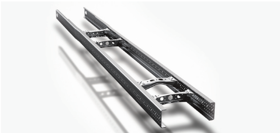
강화된 프레임 구조 프레임 두께 증대를 통한 내구성 확보
