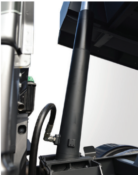
고강성 댐핑 실린더 · HYVA 제작 고강성 실린더 적용 · 동급 최대 내경 149mm
